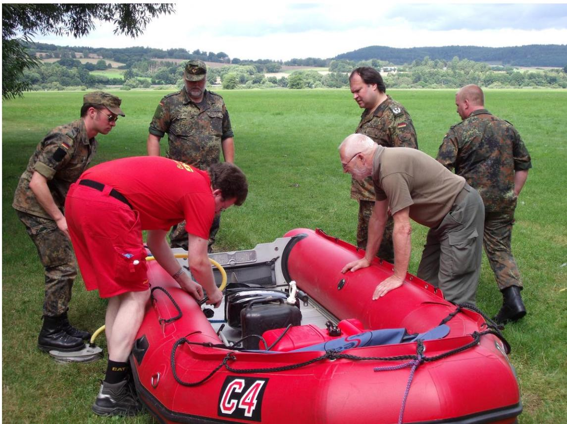
Luftdruckprüfung der einzelnen Kammern.
